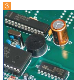
Scheda Microprocessore per controllo funzioni degassificazione, riscaldamento, ultrasuoni (versione EP). Microprocessor circuit base for degas, heating and ultrasonics (EP Version). Microprocesador para el control de las funciones degasificación-calentamiento-ultrasonidos (Versión EP).
